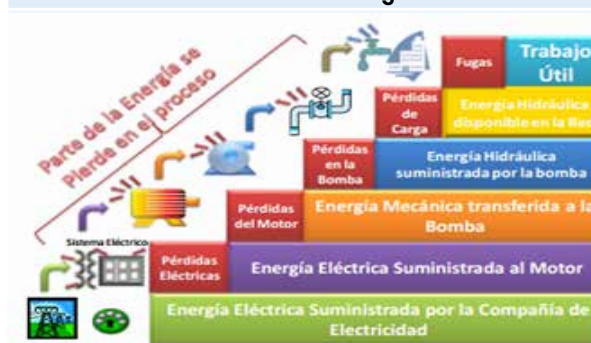
Figura 3. Esquema general, secuencia energética Balance de energía
