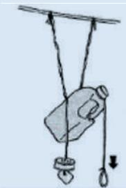
**Paso 5\*:** Caliente el clavo nuevamente, y haga dos orificios más grandes en la parte de atrás de la botella. Los orificios deben quedar más o menos en la mitad de la botella a una distancia aproximada de 2 cm. Esos orificios se emplearán para enhebrar una cuerda para colgar el recipiente. Los orificios deben estar suficientemente separados para sostener la cuerda y quedar colocados de tal manera que la botella “llena” cuelgue a un ángulo de 45°.
