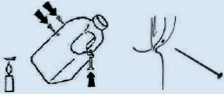
**Paso 4:** Caliente la punta de un clavo pequeño con una vela. Úselo caliente para hacer un pequeño orificio en el borde externo de la agarradera, en el punto encima de la parte sellada.
