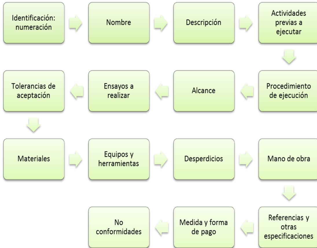
Figura 10 Contenido Especificaciones técnicas de Construcción
