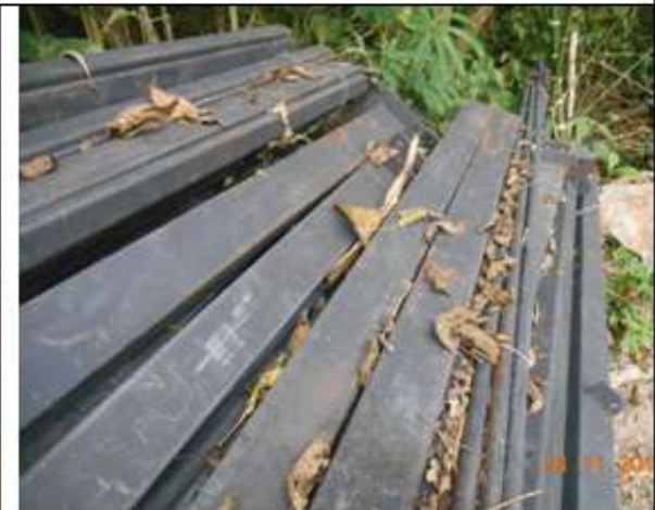
Acopio inadecuado de estructura metálica, que se está deteriorando con la vegetación.
