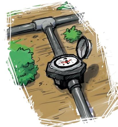
**Tuberías de distribución, conexiones domiciliarias y micromedidor:** son el conjunto de tuberías encargadas de llevar el agua hasta cada vivienda. Es fundamental que cada vivienda cuente con su llave de control para evitar el desperdicio de agua. En las conexiones domiciliarias encontramos el micromedidor o contador que registra la cantidad de agua que consume una familia
