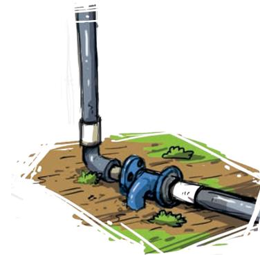
**Sistema de bombeo en fuente subterránea:** es un sistema que puede funcionar vía electricidad o combustible para impulsar el agua del subsuelo o agua subterránea por la red de conducción..
