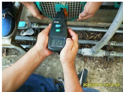
e. Medición de revoluciones con el tacómetro
