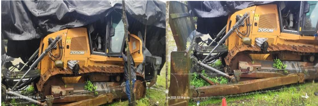
Imagen No. 2. Detalle del estado físico del sistema de tracción del Buldócer.
